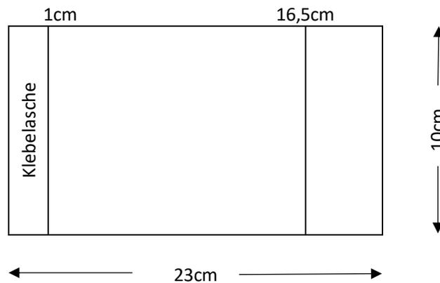
Der Farbkarton für **die Box** wird an der langen Seite jeweils rechts und links bei 6,1cm und an der kurzen Seite jeweils rechts und links bei 3cm gefalzt.
