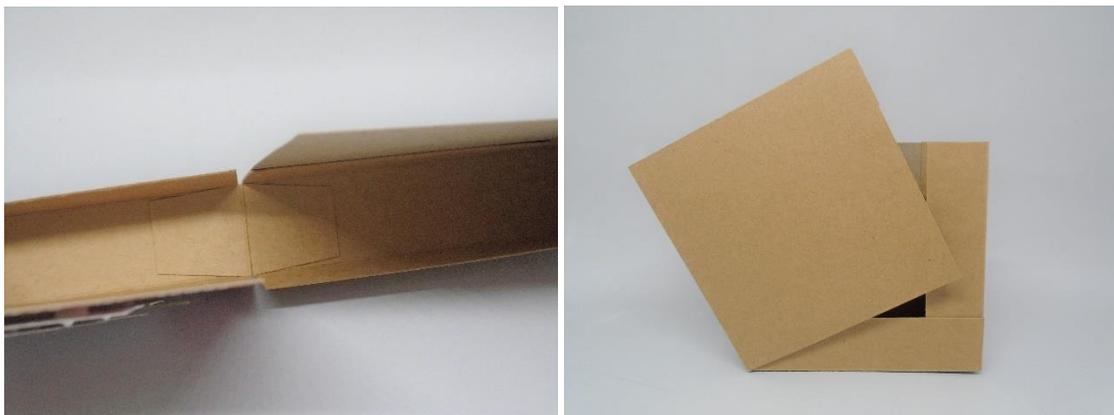
Der Verbinder wird unten an die beiden Laschen – je zur Hälfte – aufgeklebt.
